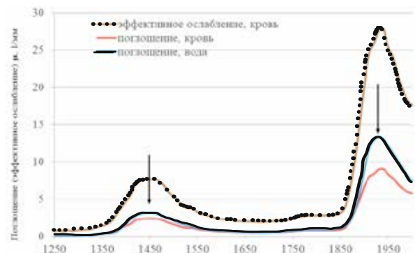
Рисунок 1. График абсорбции лазерного излучения различных длин волн кровью (гемоглобином) и водой
